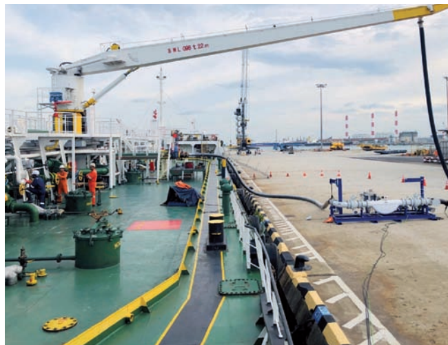
Použitelné kdekoľvek: fakturačná meracia zostava od Endress+Hauser počas overovacieho merania fakturačného meradla inštalovaného na palube ropného tankera
